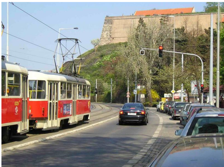
Obr. 22 Preference vozidel MHD na SZZ – Praha, Podolské nábřeží před vyšehradským tunelem (vozidla MHD projedou „úzkým“ tunelem bez kolize s individuální dopravou, která je na SZZ zastavena)
