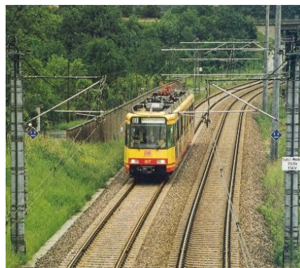
Obr. 20 a 21 Snímky z Karlsruhe – vozidla jsou v provozu jak po běžných ulicích města jako městské tramvaje, tak mohou využívat i železniční síť
