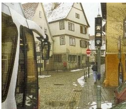
Obr. 27 a 28 Doplnění speciální signalizace pro městské autobusy, která je provázána s běžnou světelnou signalizací pro opačný dopravní směr (v tomto směru projíždí individuální doprava) – vozidla MHD proto mohou jednosměrnou ulici projíždět oběma směry
