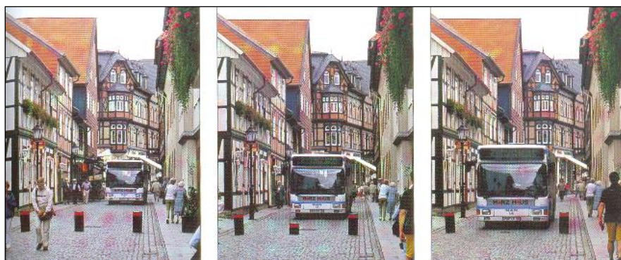
Obr. 32 a 33 Zasunovací sloupek ovládaný řidičem vozidla
