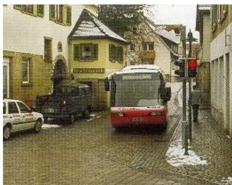
Obr. 27 a 28 Doplnění speciální signalizace pro městské autobusy, která je provázána s běžnou světelnou signalizací pro opačný dopravní směr (v tomto směru projíždí individuální doprava) – vozidla MHD proto mohou jednosměrnou ulici projíždět oběma směry
