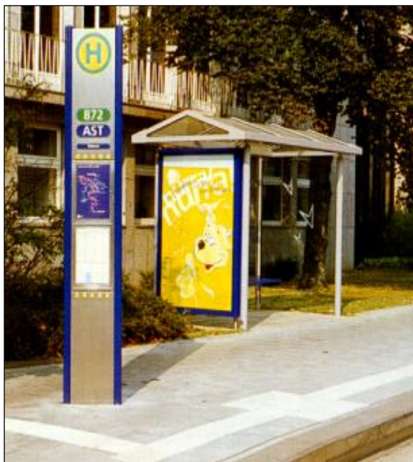
Obr. 1 a 2 Příklad navádění zrakově postižených cestujících v nástupním prostoru zastávky
